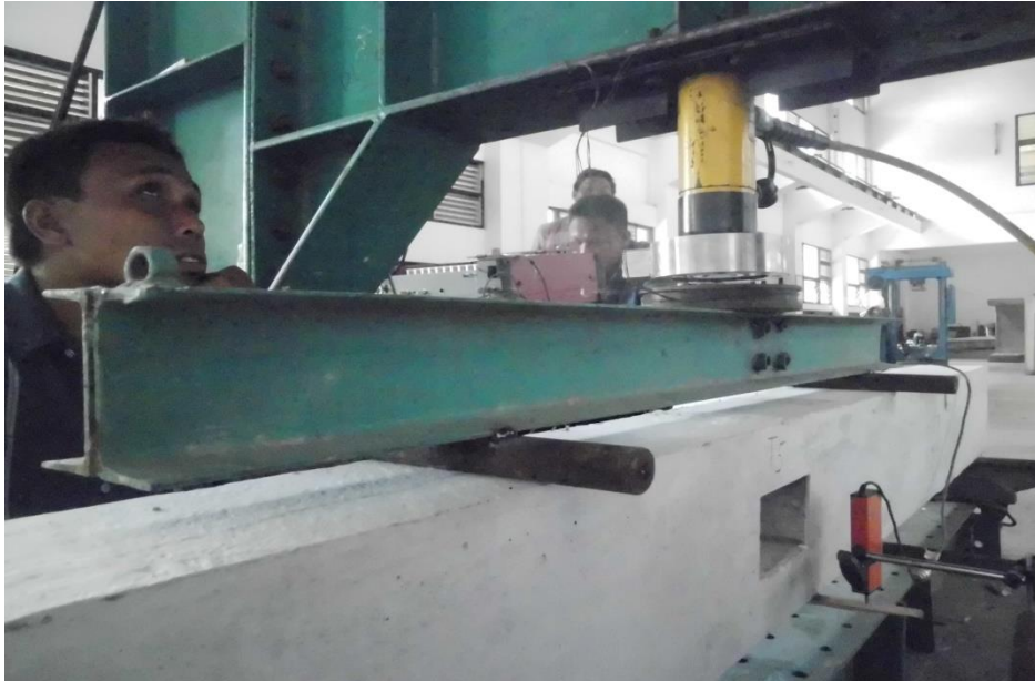
Gambar 3. Foto spesimen dengan lubang di tengah bentang
