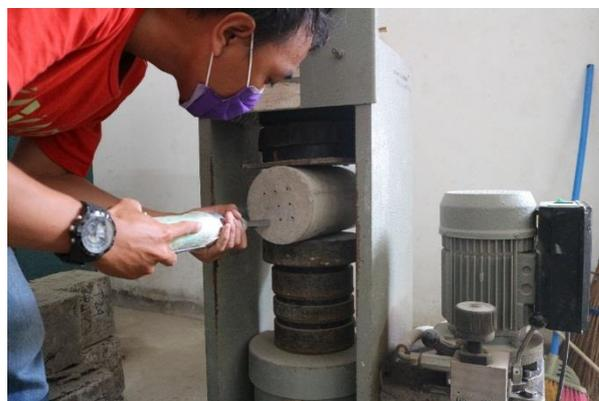
**Gambar 5.** Uji *hammer* pada silinder beton
