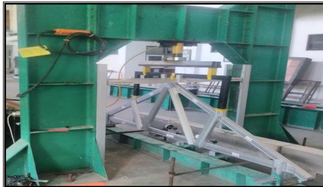
**Gambar 7.** Permodelan Rangka dan Pembebanan Kuda-Kuda
