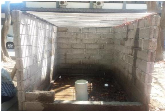
**Gambar 2.** Alat Penakar hujan manual dan Pengujian Intensitas Hujan
