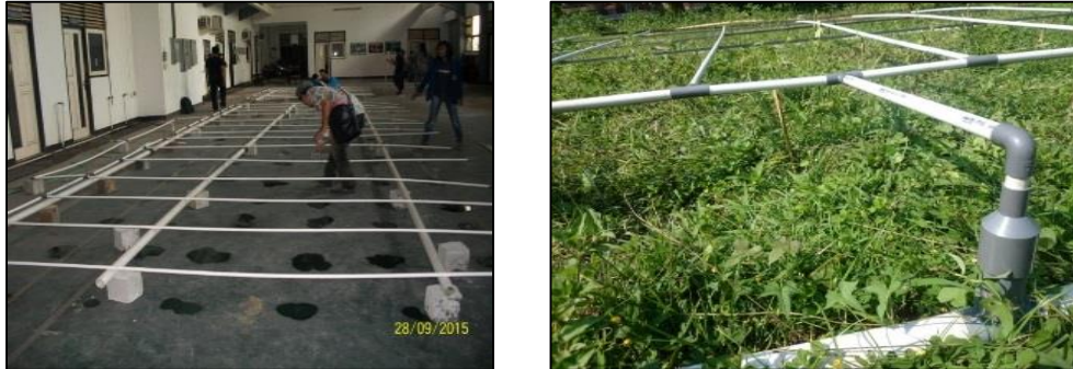
Gambar 9. Pengujian sistem irigasi tetes jaringan terbuka dan tertutup.
