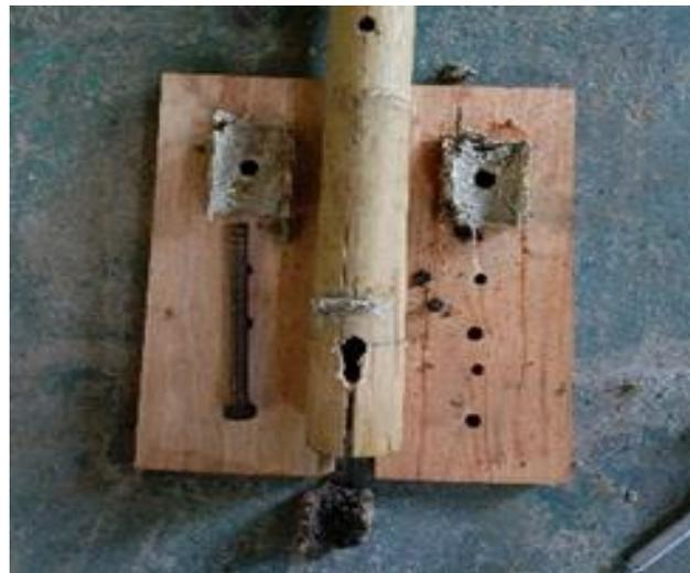
**Gambar 9** Pola kegagalan sambungan pada diameter baut 12 mm, 16 mm, dan 19 mm
