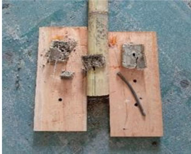
**Gambar 8** Pola kegagalan sambungan pada diameter baut 10 mm
