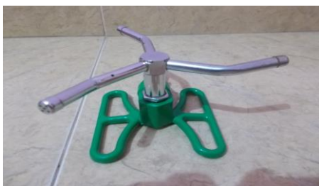
Gambar 2.a. Sprinkler Tiga Nozle
