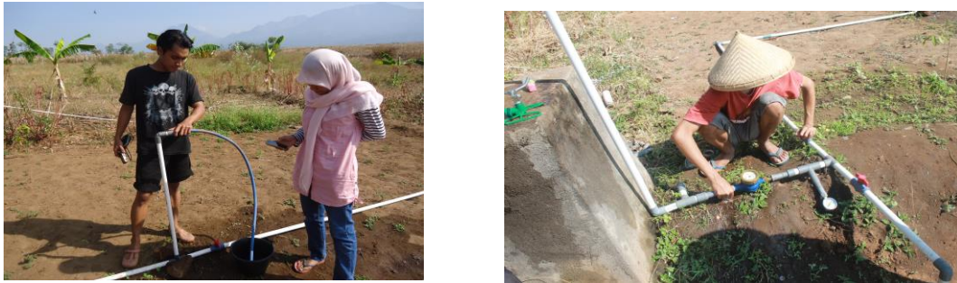
Gambar 5. Pengujian Debit Sistem Irigasi Sprinkler
