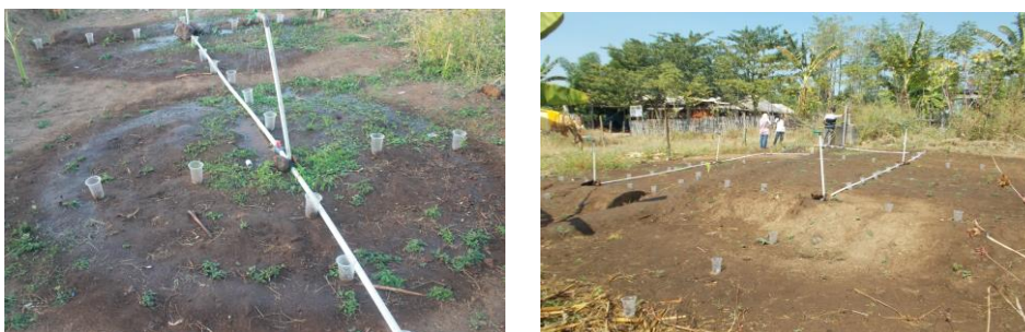
Gambar 4. Kegiatan Pengujian Keseragaman Sprinkler Mini
