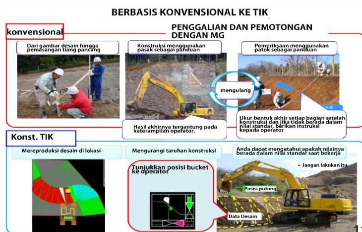
Gambar 2 Perbedaan pekerjaan sistem machine guidance dan konvensional alat berat (Sumber: Departemen teknik sipil Aichi, n.d.)
