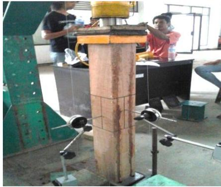
Gambar 3. Pengujian kolom kayu *hollow*
