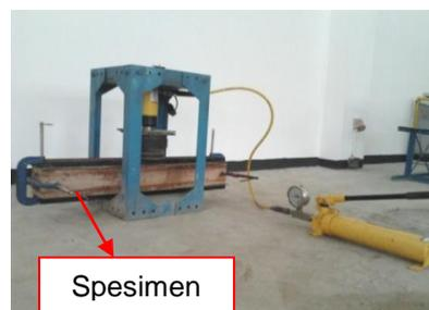
Gambar 2. Proses pengempaan benda uji kolom kayu *hollow*
