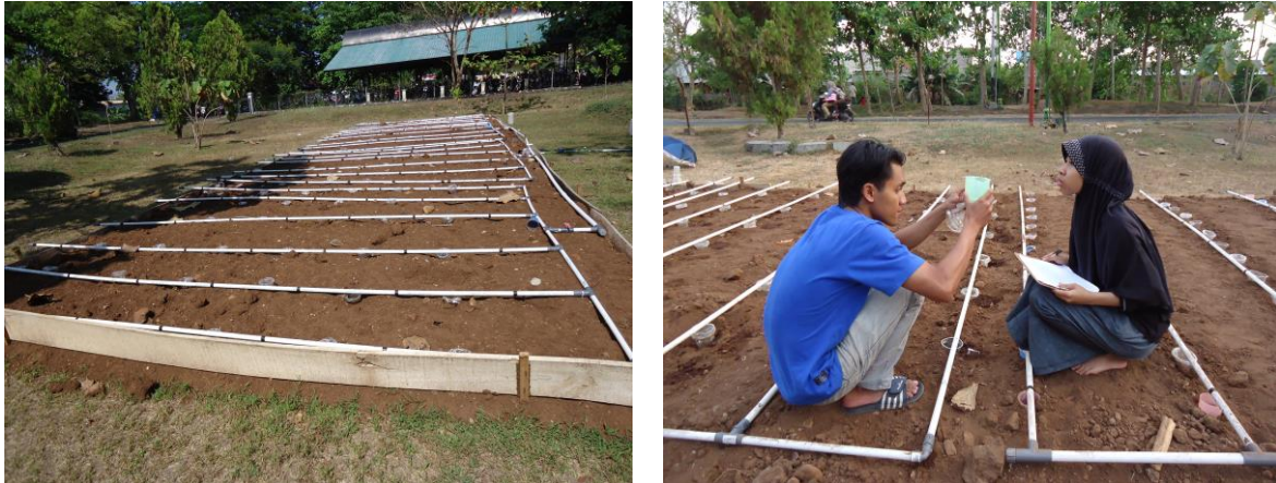
Gambar 2. Persiapan dan Pengujian Keseragaman Sistem Irigasi Tetes
