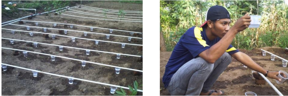
Gambar 1. Pengukuran Keseragaman Irigasi Tetes di Pringgabaya Utara
