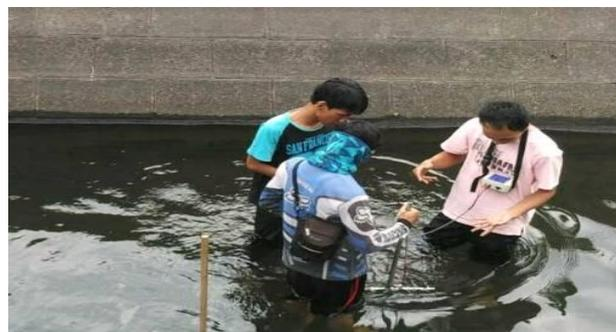
Gambar 3. Pengambilan data kecepatan aliran pada saluran utama Jangkok
