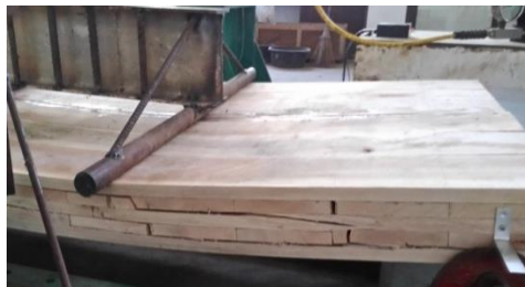
a) Keruntuhan dan Geser pada CLT penyambung lem epoxy
