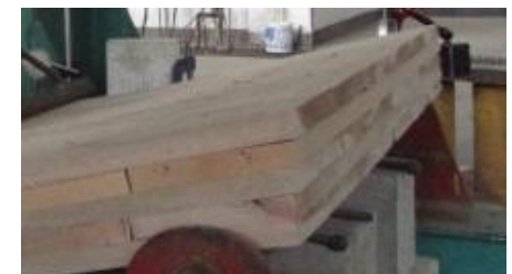
c) Keruntuhan dan Geser pada CLT penyambung pasak Jati
