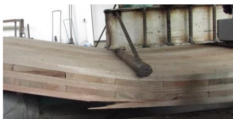
b) Keruntuhan dan Geser pada CLT penyambung pasak Bambu
