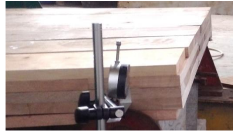
a) Keruntuhan dan Geser pada CLT penyambung lem epoxy
