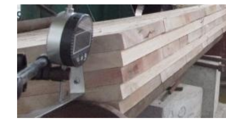
b) Keruntuhan dan Geser pada CLT penyambung pasak Bambu
