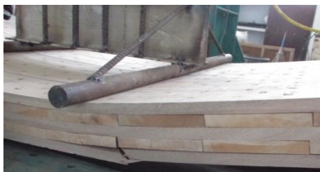
c) Keruntuhan dan Geser pada CLT penyambung pasak Jati
